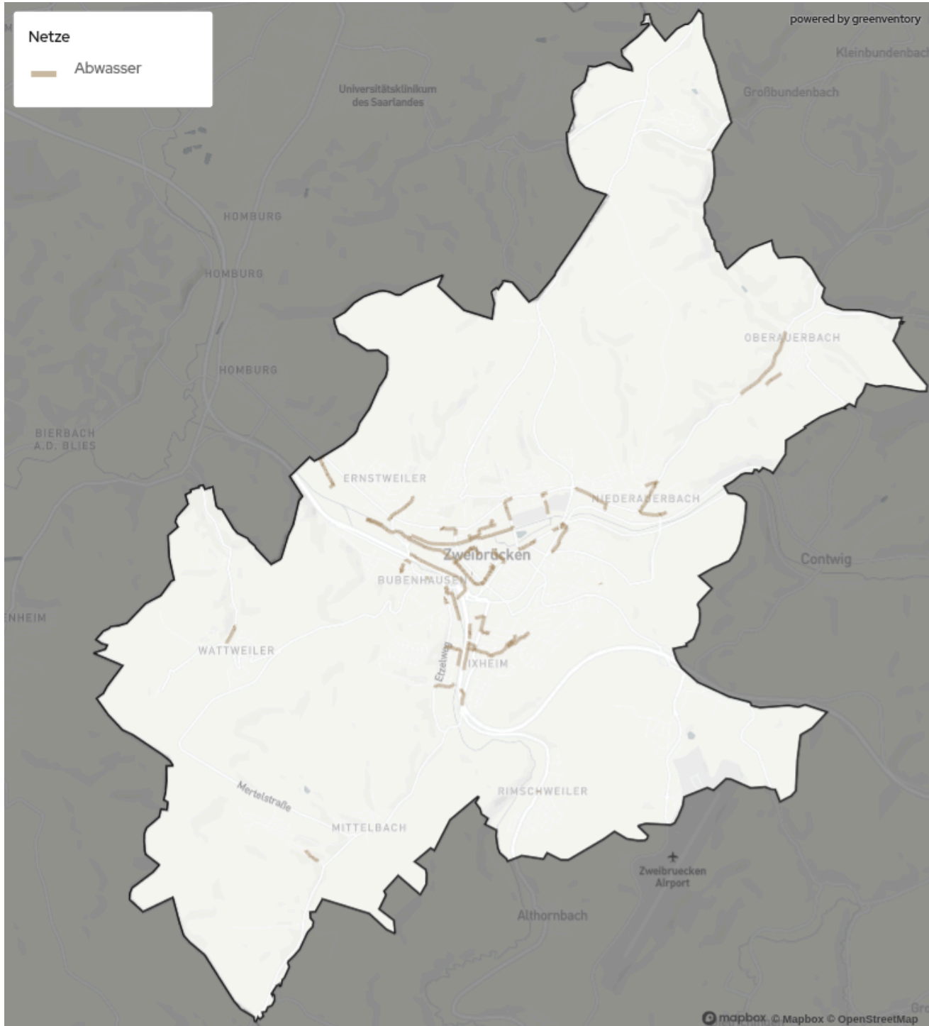
Abbildung 24: Abwassernetze mit Mindestnenngröße DN800
