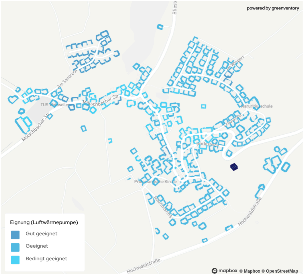
Abbildung 38: Potenzielle Aufstellflächen für gebäudenahe Luft-Wärmepumpen im Ortsteil Wattweiler
