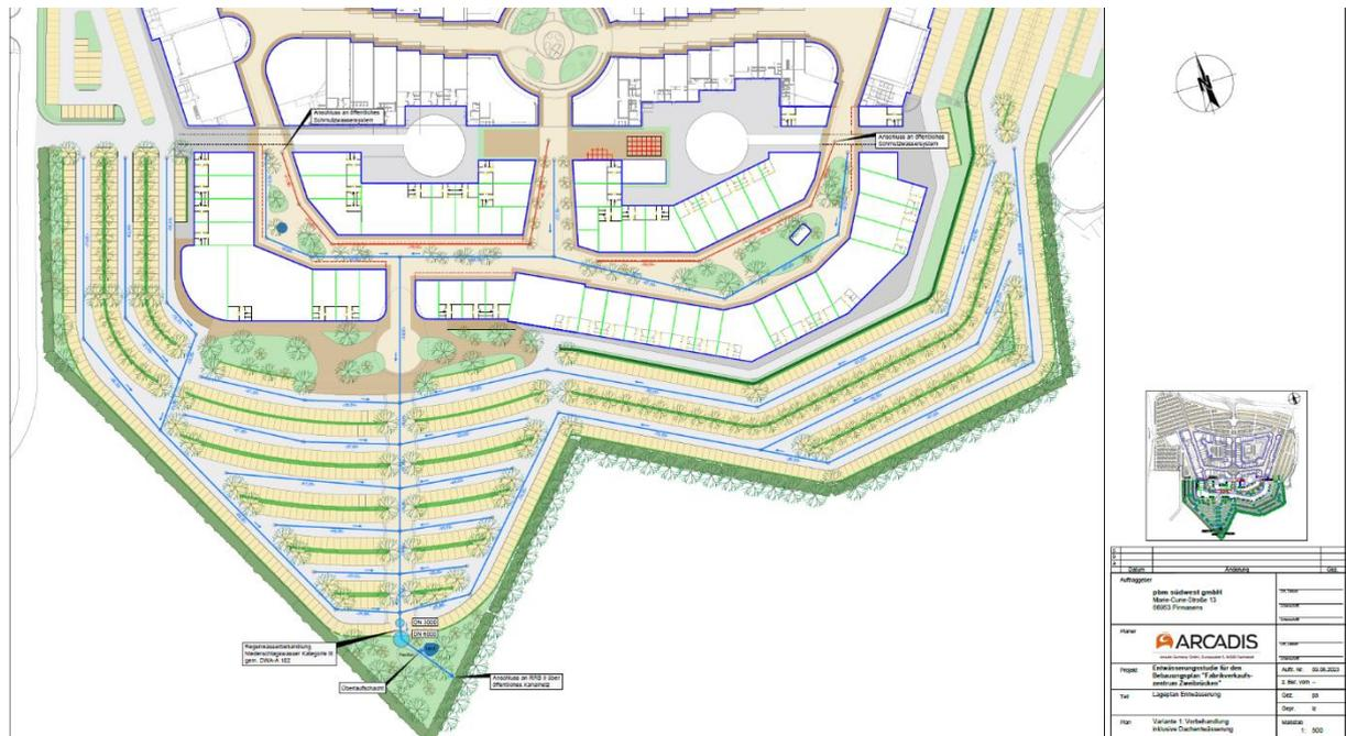
Abbildung 36: Lageplan Entwässerung: Variante 1: Vorbehandlung inklusive Dachentwässerung (ARCADIS, 2023; vgl. Anlage 18).
