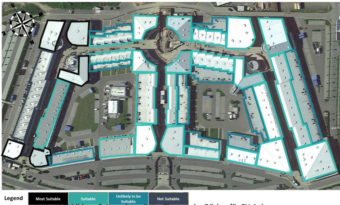
Abbildung 6: Lageplan mit der Eignung der Dächer für PV-Anlagen
