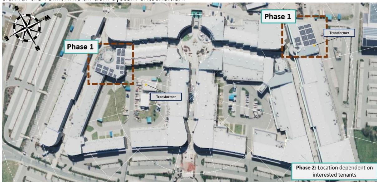
Abbildung 11: 150 kWp (Phase 1) nach Süden ausgerichtete PV-Anlagen auf dem bestehenden Dach
