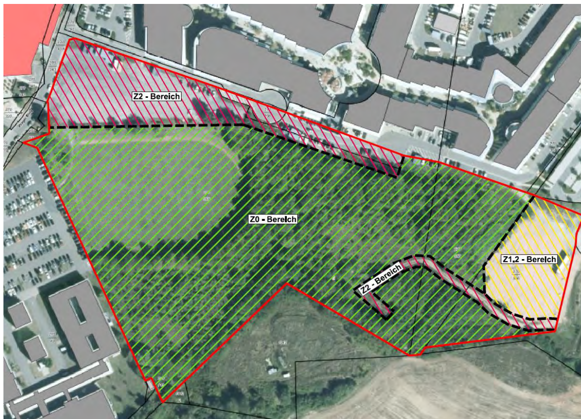
Abbildung 15: Übersicht „Bodenbelastungen nach LAGA TR Boden (Auszug aus ROTH & PARTNER 2025A, Anlage 10)
